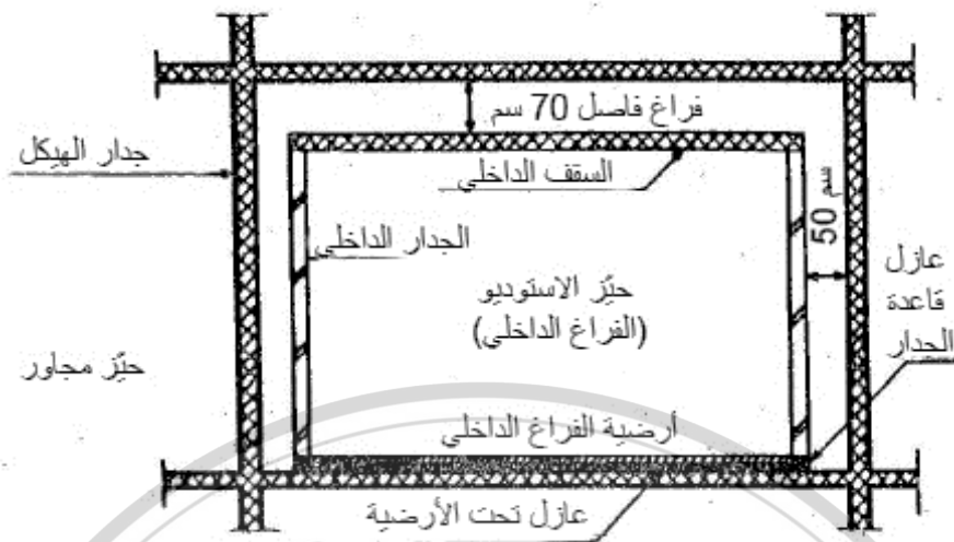
شكل (٥٨ أ-٢) عزل فراغ الاستوديو عن الفراغ المحيط
