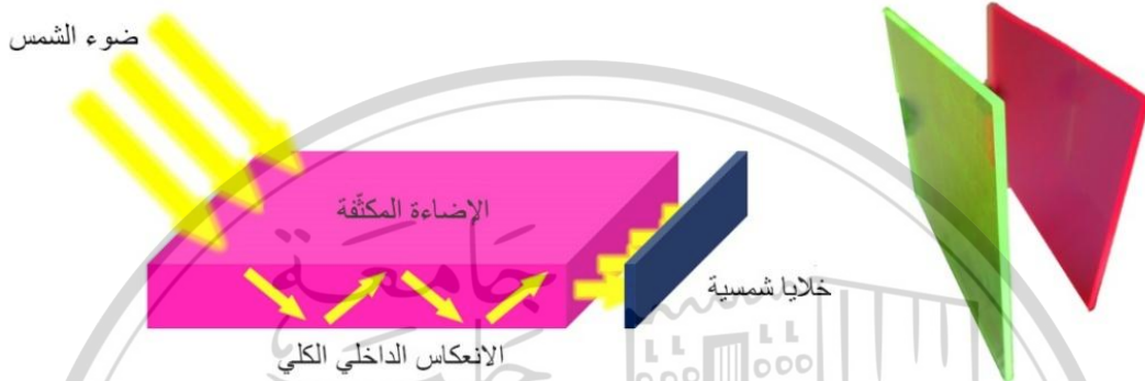
شكل (١١٥) توليد الطاقة الكهربائية من انعكاس الضوء على الزجاج باستخدام مكثف شمسي
