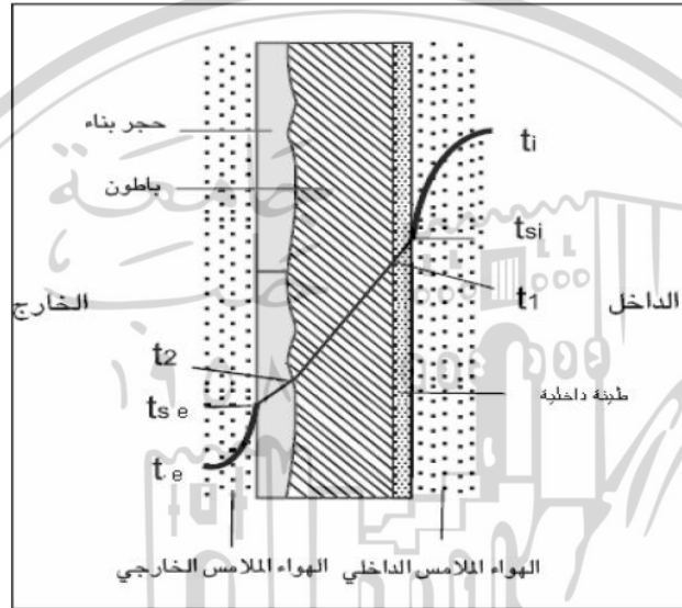
شكل (١٩) توزيع درجات الحرارة خلال عنصر إنشائي متعدد الطبقات
